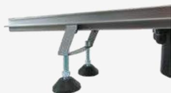
Piedini regolabili per altezze da 98 a 127mm (misura pavimento finito) che consentono di adattare i canali al massetto e di livellarli per uniformarli alla pavimentazione.
