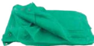
Rete verde per ponteggi in monofilo HDPE con occhielli metallici per il fissaggio ogni 50 cm. Indispensabile per impedire che pietre, calcinacci o altri detriti cadano all'esterno danneggiando persone o cose. Obbligatoria in campo edile in seguito all'art. 28 del DPR 164/56.
